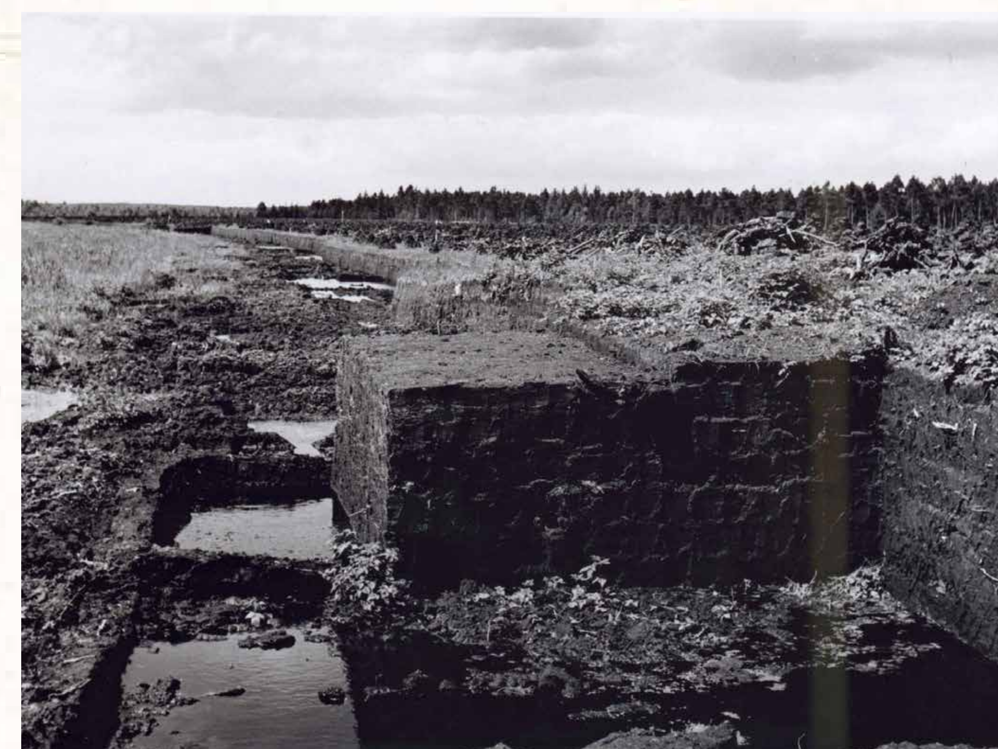
Při ruční těžbě se ročně vypichal pruh široký 4–5 m do hloubky 3–4 m až ke spodní vodě.
